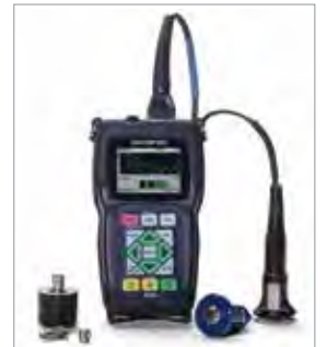
Ultrasonik Et Kalınlığı Testi / Ultrasonic Portable Wall Thickness Test
